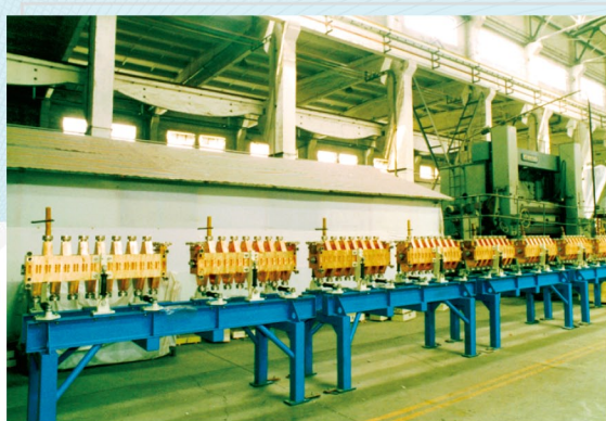
■ 为美国超级超导加速器 SSC 研制的边耦合腔
