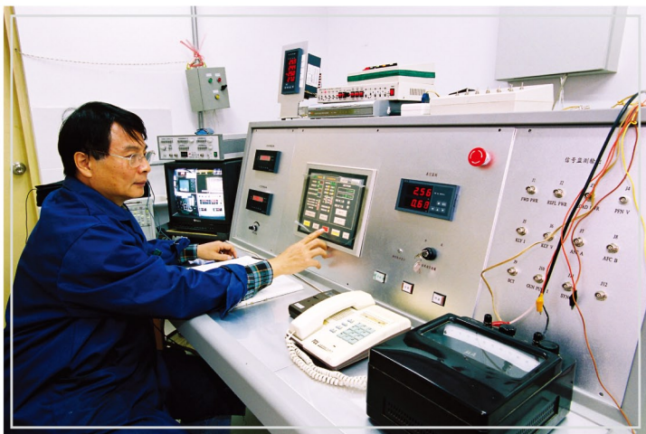
■ 左图为10MeV/15kW工业辐照电子直线加速器，右图为其控制台 用途：医疗卫生用品的消毒灭菌、食品保鲜、谷物杀虫等
