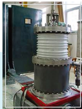
■ 150kV/10mA超小型、自屏蔽、高寿命电子帘加速器 用途：可广泛用于表面涂层固化、包装消毒、食品和种子的表面杀菌、医疗器械的消毒、空气消毒和净化处理
