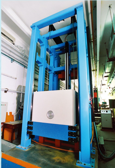
■ 6MeV加速器射线源大型工业断层扫描设备
