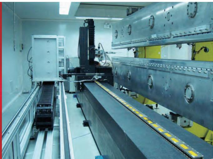
▷ 中国散裂中子源 (CSNS) 强流质子加速器, 突破其中的关键技术, 自主设计建成我国第一台高束流功率射频四极加速器 (RFQ)。积极开展加速器驱动的次临界系统 (ADS) 的强流质子加速器的 R&D 和研制。
