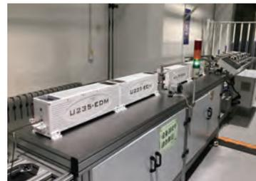
③ 核燃料富集度无源检测系统，正式上线投入使用
